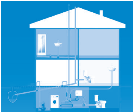
图1：潜水泵安装示意图：
